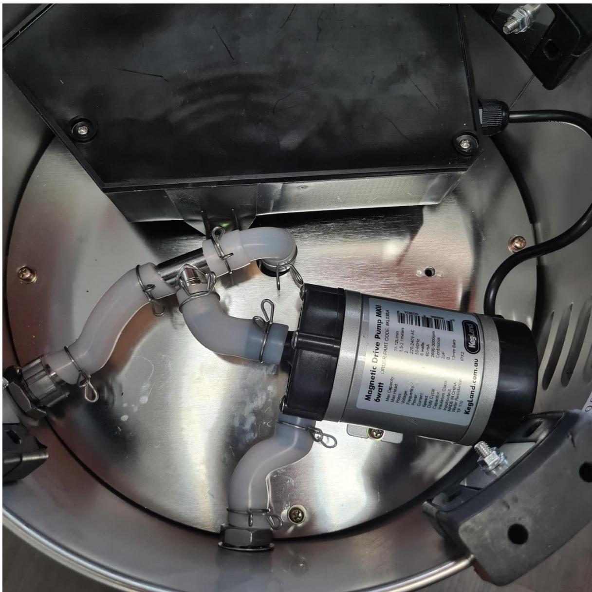
Asegúrese de que la manguera de silicona no presenta dobleces ni torsiones que puedan impedir el flujo del líquido. Si hay algún pliegue, puede producirse un aumento de presión y la rotura de la manguera.
