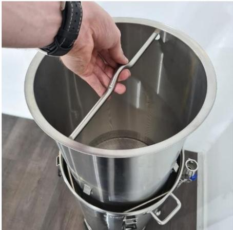
A continuación, el tubo de malta Gen 4 tiene ahora una capacidad de filtración escalonada con soportes de pie añadidos a mitad del tubo de
