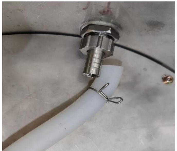
Empuje la manguera de silicona no conectada de la bomba sobre la lengüeta del grifo y fíjela en su sitio con la abrazadera de alambre.
