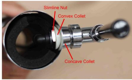
NOTA: Es importante que el usuario no apriete demasiado el collarín del grifo. Un apriete excesivo de esta pieza impedirá el movimiento libre y completo de la maneta del grifo. Un apriete excesivo restringirá el movimiento de la maneta del grifo impidiendo que éste se abra completamente de forma adecuada.
