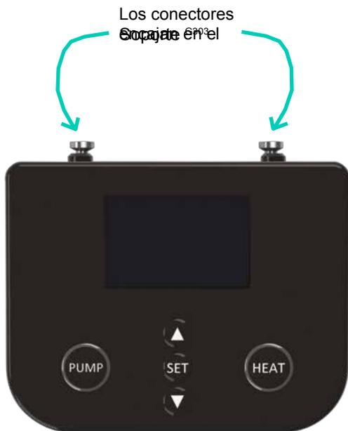
Inserte el enchufe de la bomba (23) y el enchufe de la resistencia (21) en las tomas correspondientes de la parte inferior del regulador, tal como se muestra a continuación.
