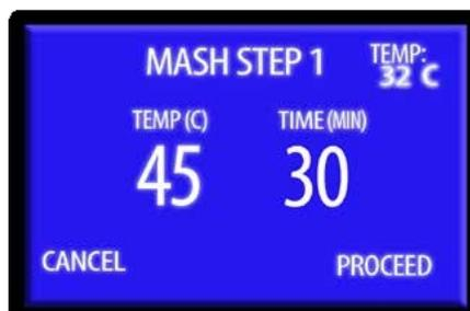
4. Pulse arriba o abajo para cambiar la hora de ese paso.
